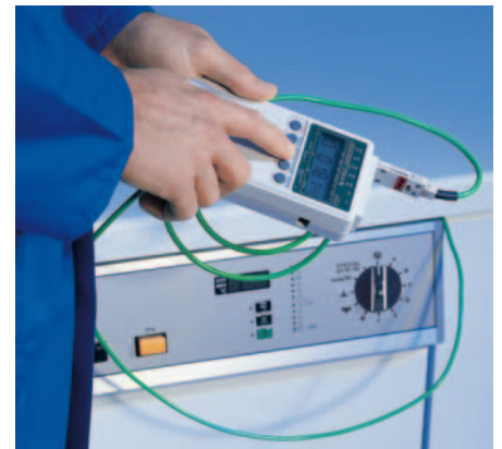
Acceso para la medición, para el control independiente del mantenimiento de la temperatura
