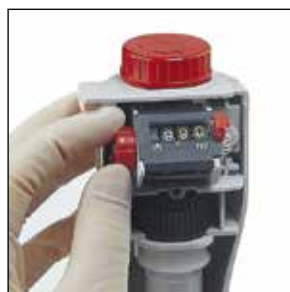
3. Retirar el botón giratorio rojo y ajustar el valor real determinado (aquí 9,90 ml).
