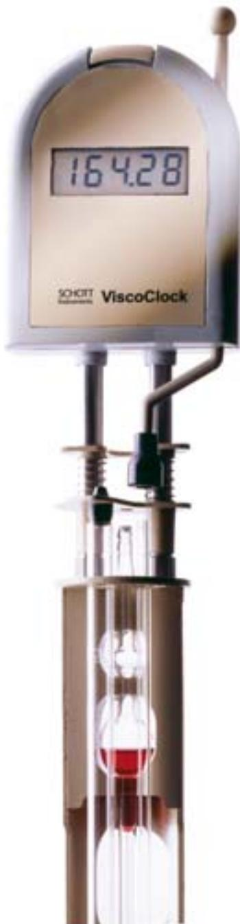
Los siguientes líquidos son adecuados para estabilización de la temperatura en un baño termostático: agua, alcohol de agua (etanol, metanol), aceite de parafina y aceite de silicona. Los líquidos a medir deberán estar calificados para su uso con el viscosímetro en cuestión.
