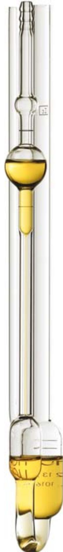
*Los viscosímetros capilares de SCHOTT Instruments son la base de una medición precisa de viscosidad en fluidos newtonianos.*
