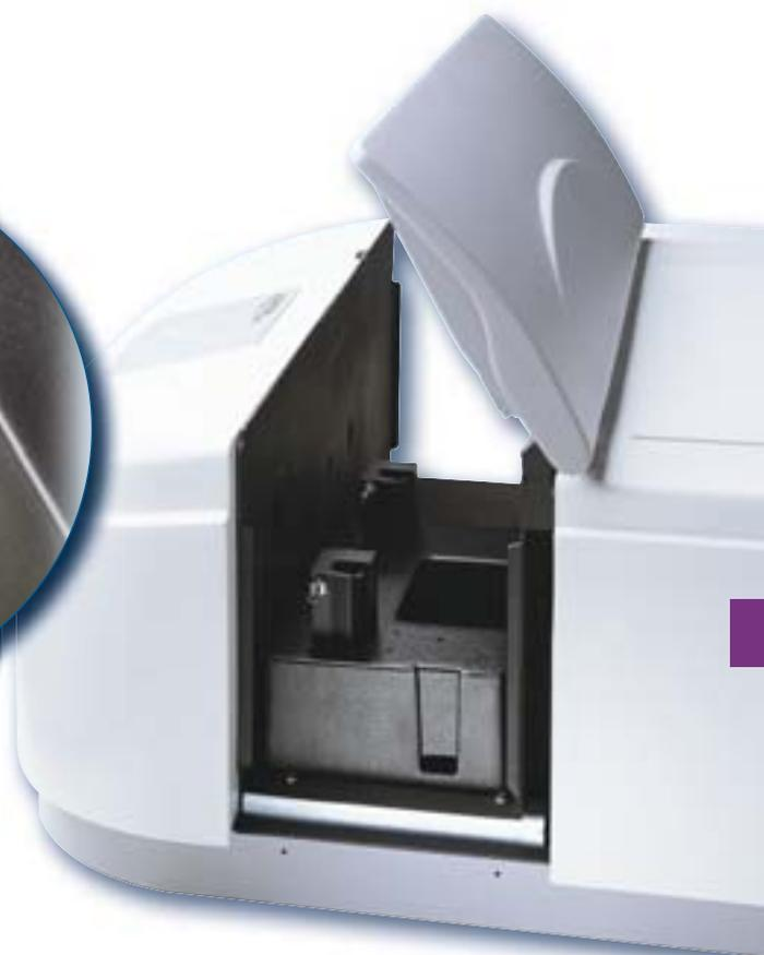
*El contenedor de muestras del UVIKON está diseñado para ahorrar el máximo de tiempo. Hay suficiente espacio para insertar la muestra sin problemas y se puede cambiar de accesorio en cualquier momento. El mantenimiento es increíblemente sencillo.*
