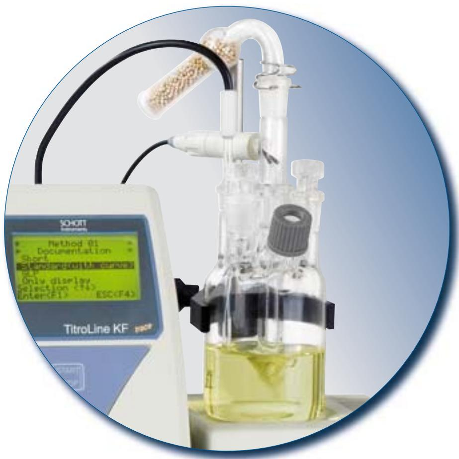
Los contenedores de titulación están herméticamente sellados para evitar la entrada de humedad y mantener la mínima desviación. Para el TitroLine KF ofrecemos dos contenedores de vidrio que se pueden quitar, son fáciles de limpiar y vienen en dos tamaños. Para el TitroLine KF *trace* se utilizan dos contenedores diferentes con 3 y 5 aberturas, ambas con desviaciones mínimas.
