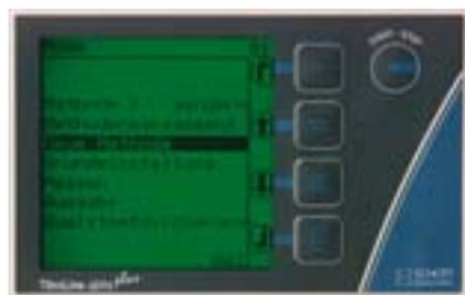
Utilice las flechas (teclas centrales) para navegar hacia arriba o hacia abajo en el menú, confirme su selección con un Enter (tecla de abajo). Utilice ESC (tecla superior) para salir del menú.
