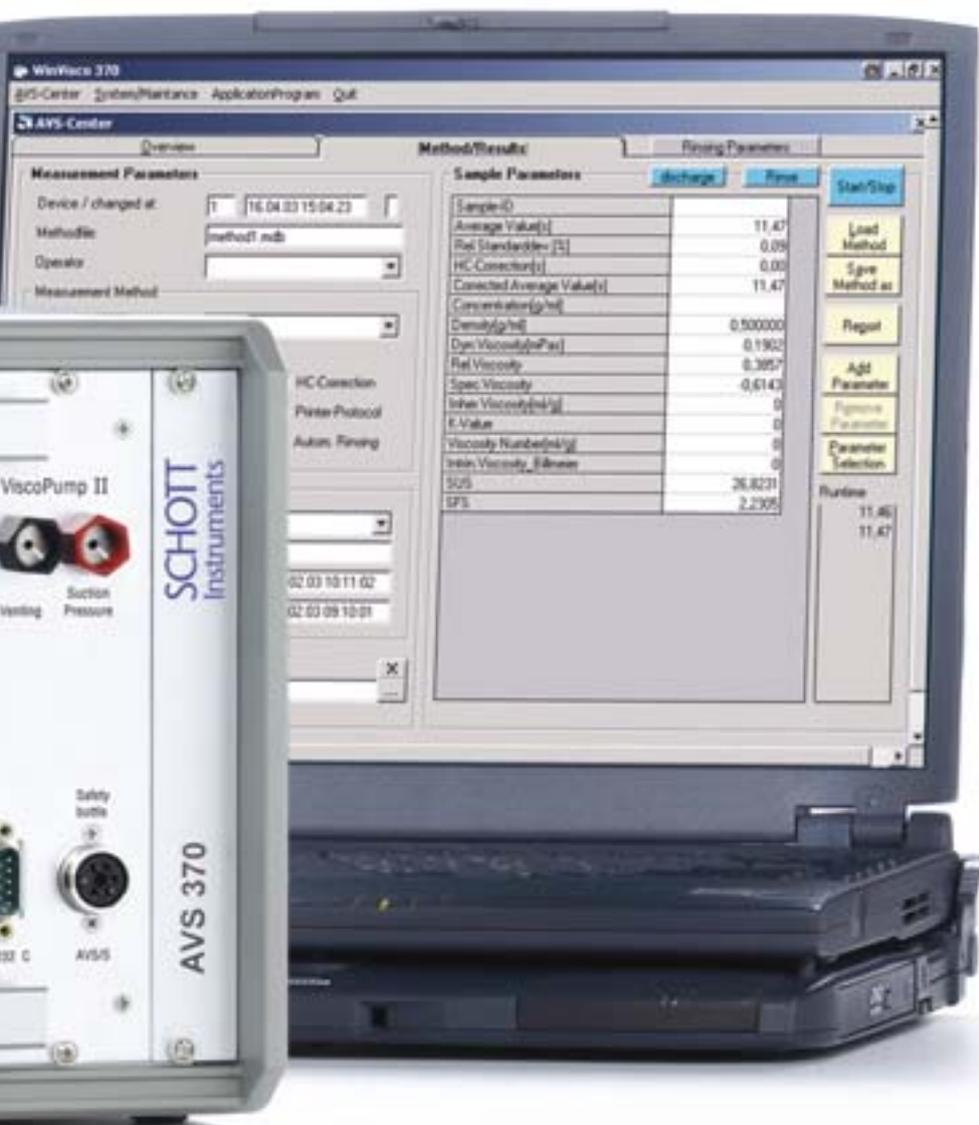
ViscoSystem® AVS 370 de SCHOTT Instruments. Se pueden integrar hasta cuatro módulos ViscoPump II en la construcción de 19". Con una PC y el software WinVisco 370 se pueden medir, evaluar y documentar todo tipo de muestras en paralelo e independientes una de la otra.
