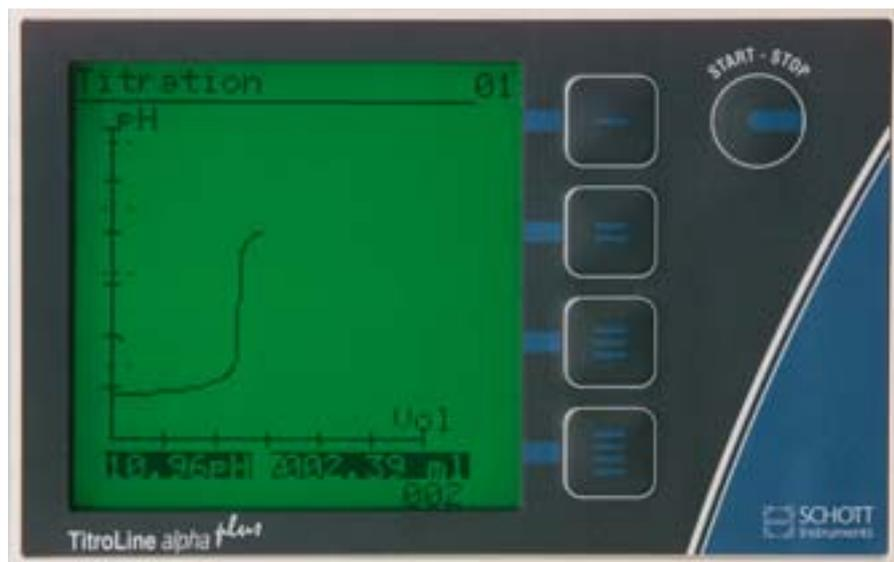
Durante la titulación, el usuario puede observar el procedimiento completo en tiempo real con la curva de la pantalla, no es necesario esperar a la impresión. De esta manera nunca se pierde el control del proceso.
