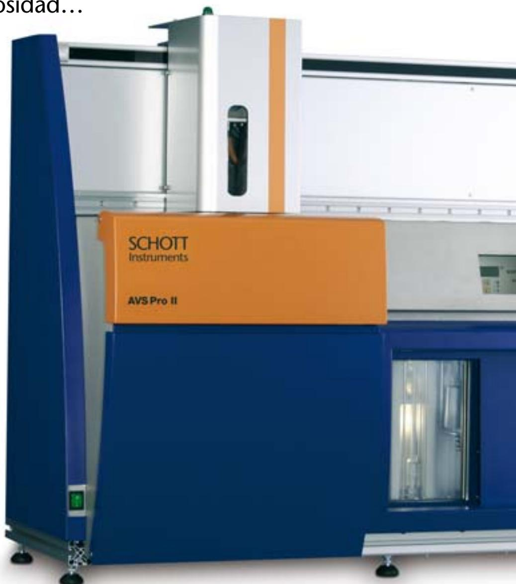
Ya se ha mencionado que el método capilar es el más preciso para la determinación de la viscosidad de líquidos newtonianos. Es precisamente el uso de este método lo que hace del AVSPro II un instrumento en el que se puede confiar, pues no es inusual obtener una exactitud de más de 0.1%. Además, es posible utilizar viscosímetros de sistema óptico o de sensores TC lo que permite aplicaciones desde líquidos claros hasta productos petroquímicos opacos.
