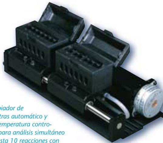
*Cambiador de muestras automático y con temperatura controlado para análisis simultáneo de hasta 10 reacciones con enzimas.*
